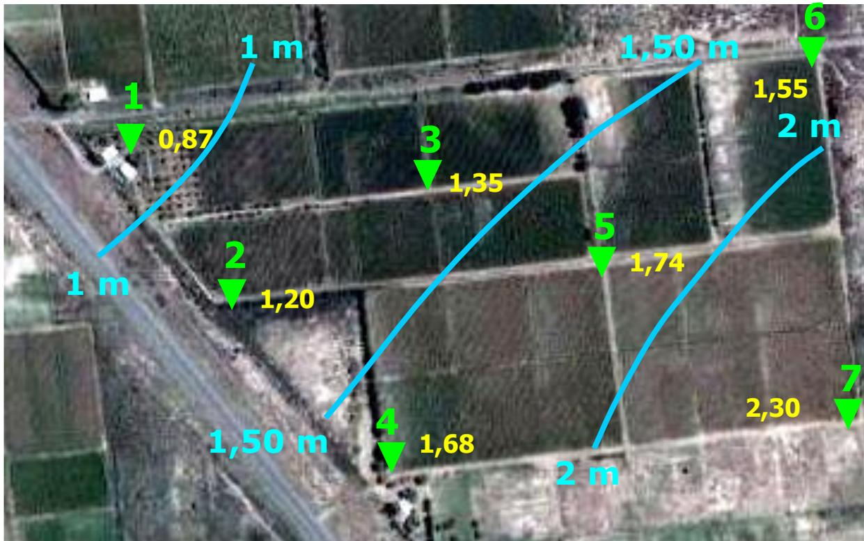
**Figura 8.** Red de freatómetros y curvas de igual profundidad freática
