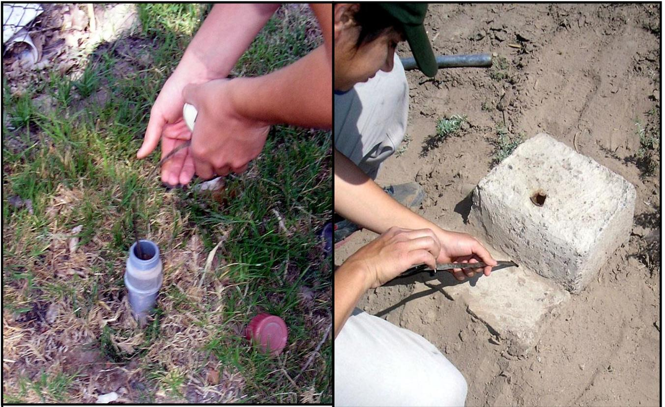
**Figura 7.** Medición de la profundidad del agua con cinta en freaímetros.
