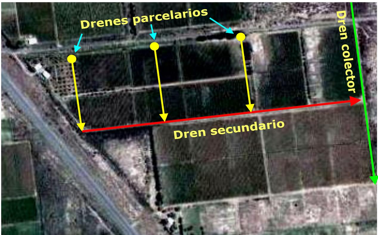
**Figura 9.** Trazado de una red de drenaje parcelario
