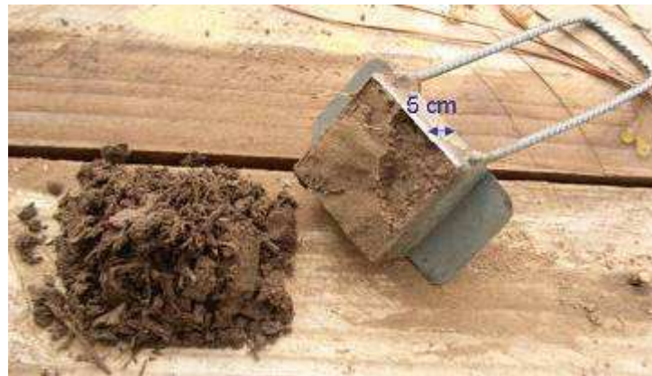
Figura 2.9. Instrumento utilizado para extraer muestras de suelo para determinar humedad en el suelo.
