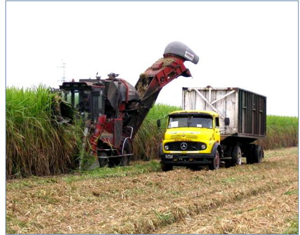
Figura 2.2: Máquina utilizada en la cosecha convencional. Peso aproximado 12.000 kg
