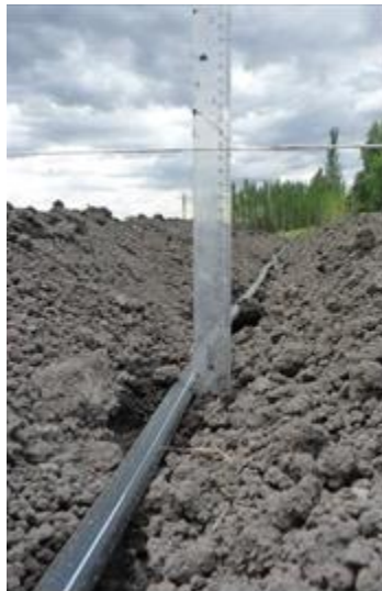
Figura 3.- Tratamiento SUB, cinta enterrada a 20 centímetros.
