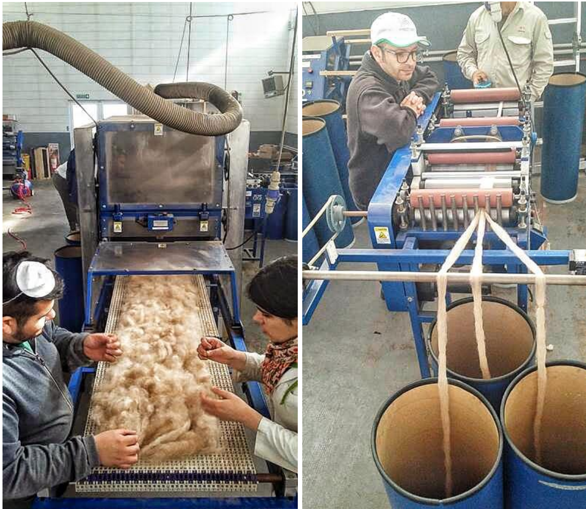
Fotografía 4: Cardado de fibras de cabra colorada pampeana (izquierda) y estiramiento controlado de cinta de carda (derecha) para obtener la densidad lineal recomendada en la hilatura.
