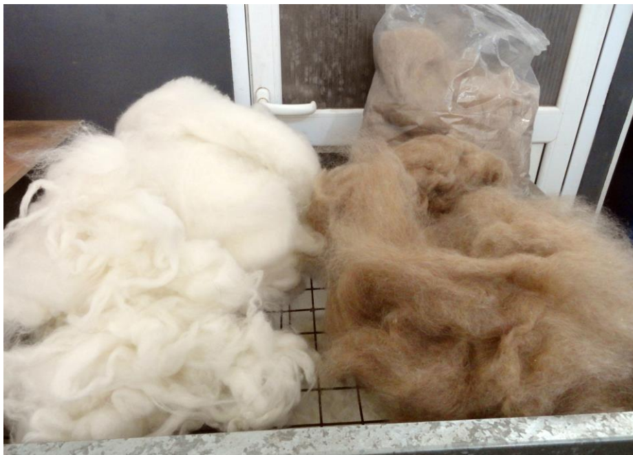
Fotografía 3: Preparación de fibras para el procesamiento de hilo Camel mediante partes iguales de lana Merino fina y subproductos del descordado de pelo de cabra colorada pampeana.
