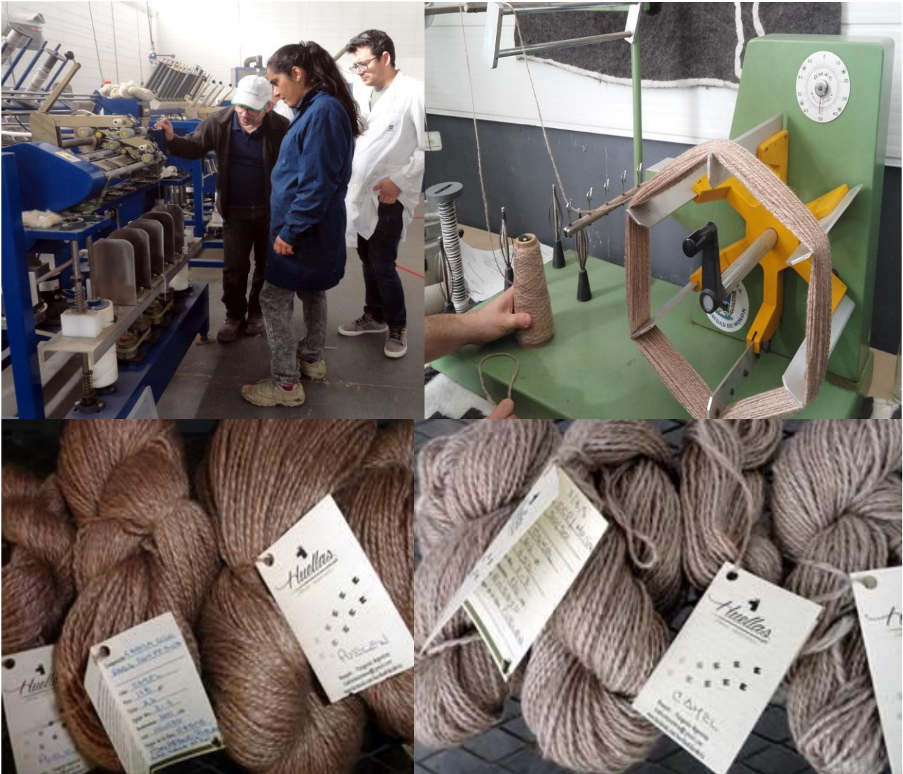
Fotografía 5: Arriba Controlando la hilatura (izquierda) y estimación del título de hilado (derecha). Abajo, madejas de hilo puro de pelo de cabra colorada pampeana (izquierda) y mezcla de pelo de cabra colorada pampeana con lana Merino (derecha).
