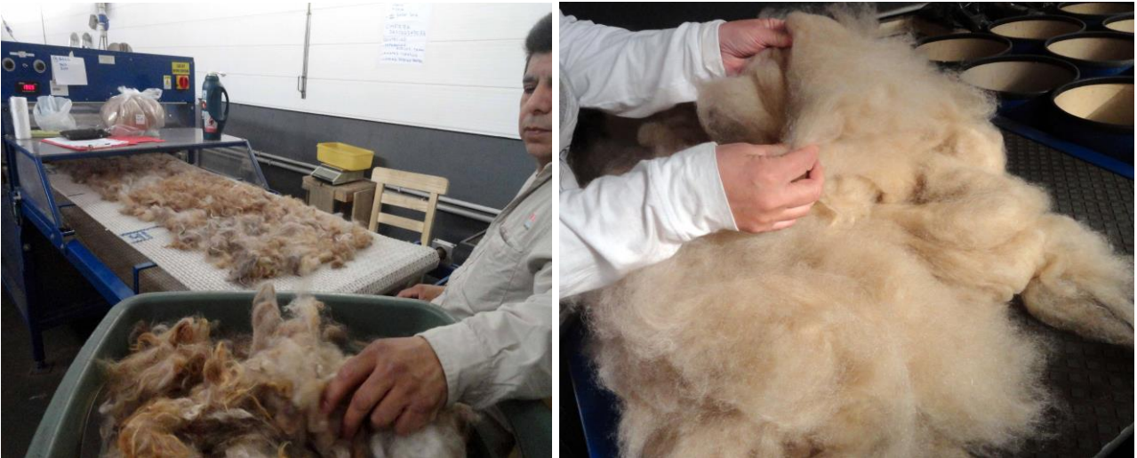
Fotografía 2: Alimentación de la maquina descerdadora (izquierda) y producto final descerdado (derecha).
