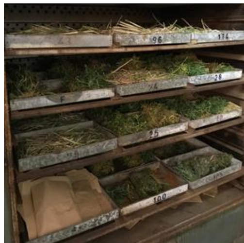
Figura 5. Estufa donde se secan las muestras durante 48 h.
