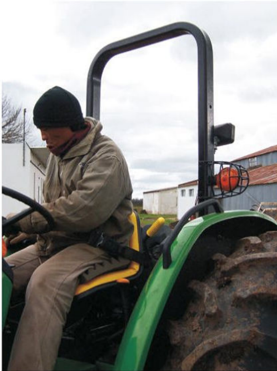
Cinturón de seguridad y barra antivuelco en tractor
