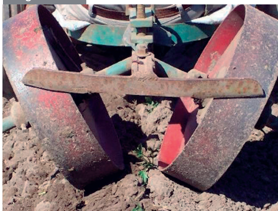
Ruedas compactadoras de una trasplantadora de batata, que comprimen el suelo alrededor de la planta. Fotografía: Héctor Martí.
