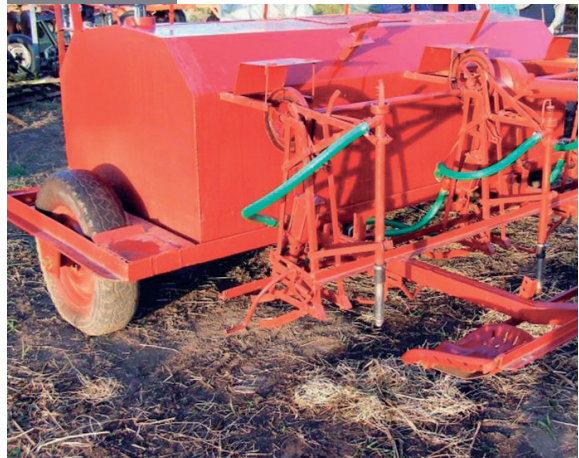
Trasplantadora de batata de tres surcos con caño regador. Fotografía: Héctor Martí.
