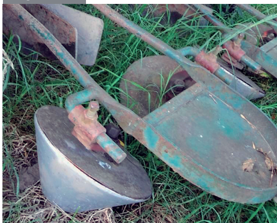
Trasplantadora de batata mostrando el azadón abre-surco y los rolos compactadores. Fotografía: Héctor Martí.
