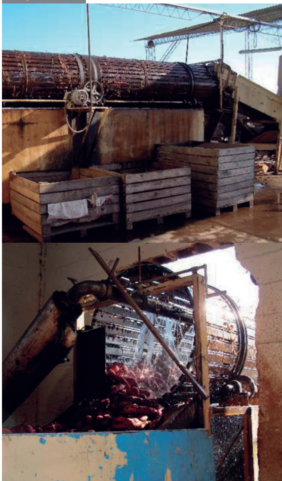
Lavadora de batata. Vista general (izquierda) y detalle del cilindro lavador (derecha). Fotografía: Héctor Martí.
