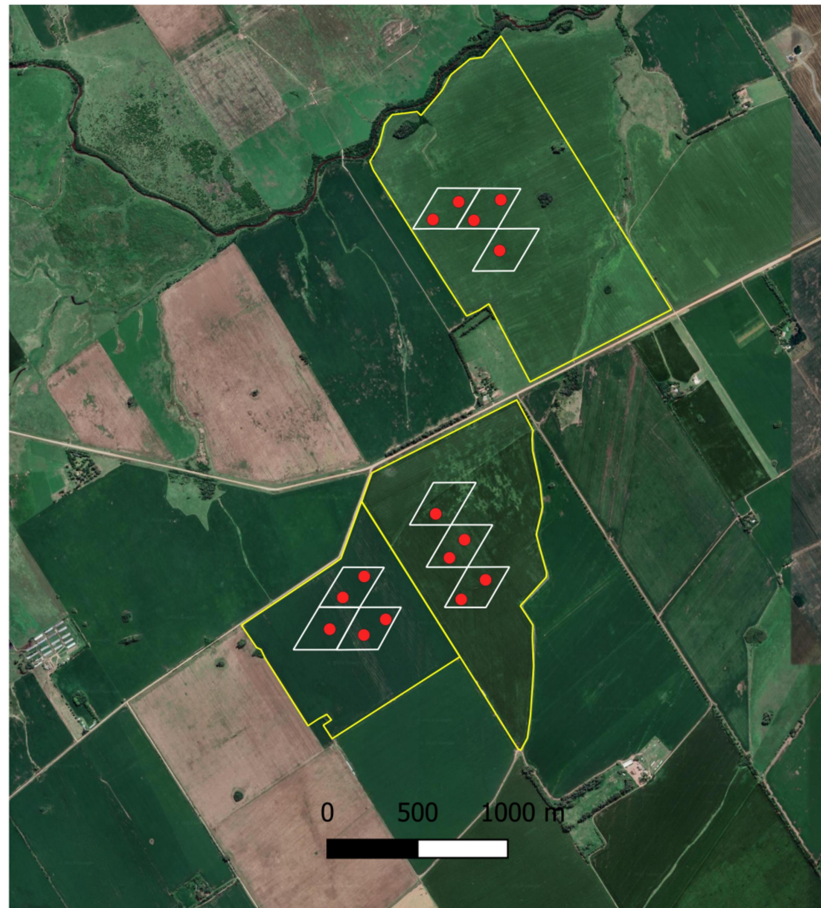
Figura 3.2. Ejemplo de la configuración espacial de las mediciones a campo. Puntos rojos: sitios de muestreo; polígonos blancos: contorno de píxel de la plataforma MODIS en proyección sinusoidal; polígonos amarillos: borde de lote de cultivo.
