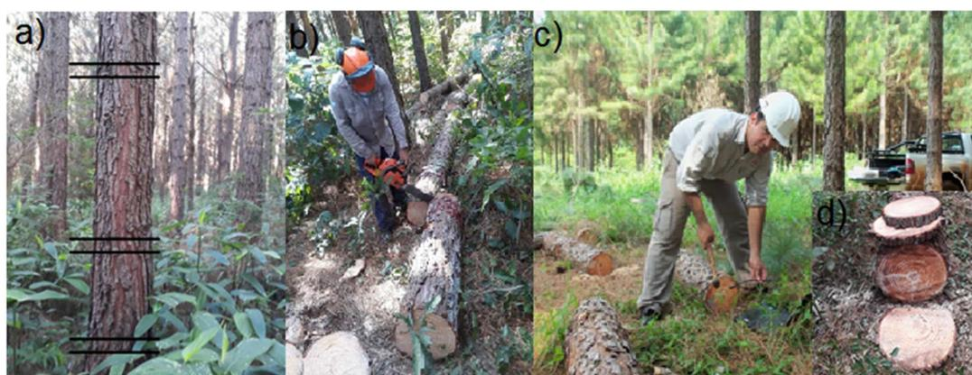
**Figura 10: a) Marcación de rollizos, b) Trozado y c) Medición de frecuencia natural de vibración resonante de la onda y obtención de rodajas en ambos extremos del rollizo.**
