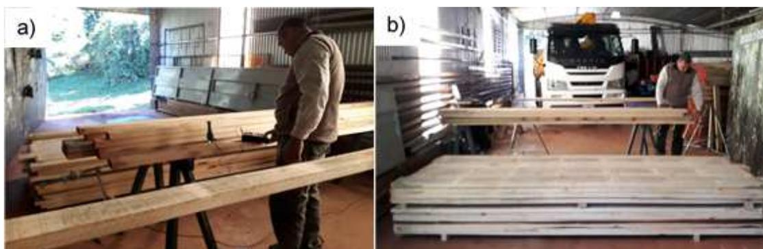
**Figura 11: a) Medición del contenido de humedad con xilohigrómetro. b) Apilado para posterior medición del MOE dinámico.**
