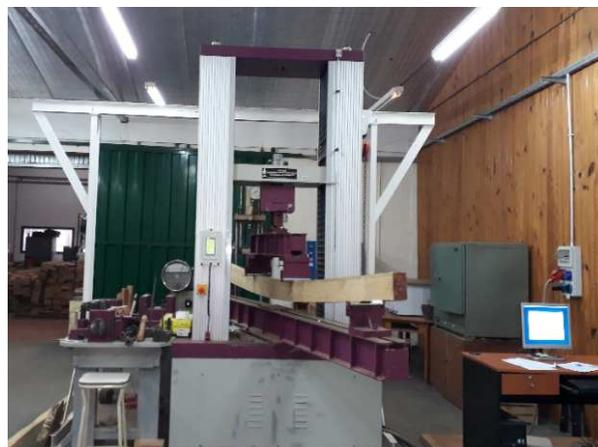
**Figura 16: Cuerpo de prueba ensayado a la flexión estática.**
