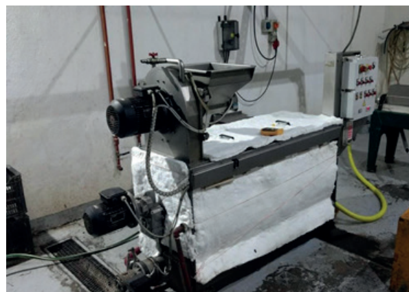
Figura 2. Termobatidora industrial (200kg/h) empleada para realizar los tratamientos y obtener la fracción líquida desfenolizada.
