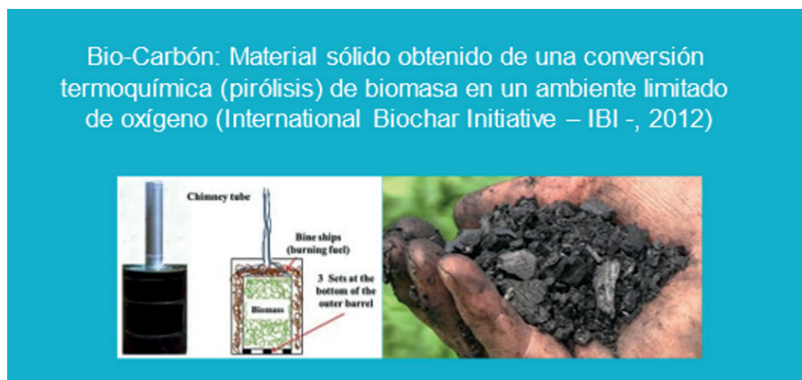
Figura 1. Vista del horno pirolítico y el Bio-Carbón obtenido.
