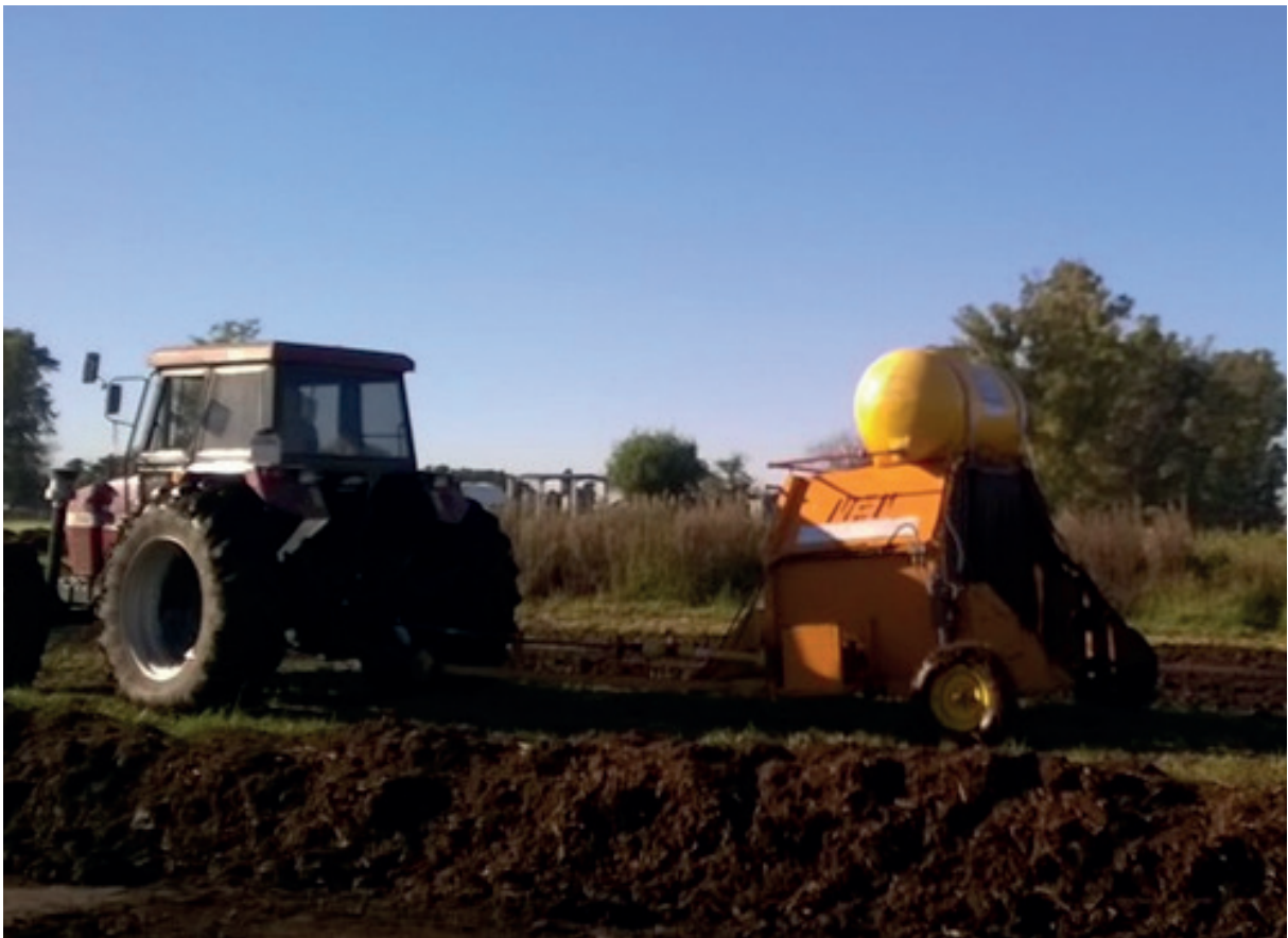
Figura 1. Pila de compost de residuos provenientes de instalaciones de cama profunda y removedora de compost.
