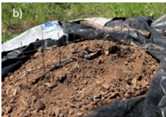
Figura 1. a) Ubicación y profundidad de las tomas de temperatura en las pilas altas, b) Minipila con estructura metálica soporte de los sensores de temperatura de los equipos data logger.
