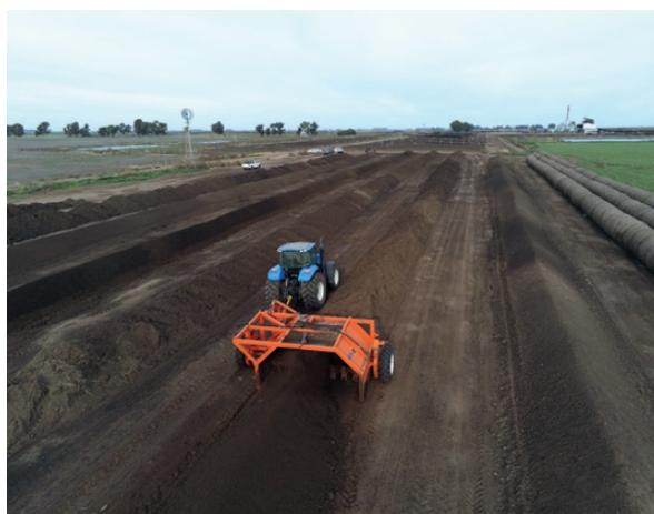
Figura 2. Mecanización del volteo de pilas de compostaje con equipo removedor Deisa de Agropecuaria La Criolla.
