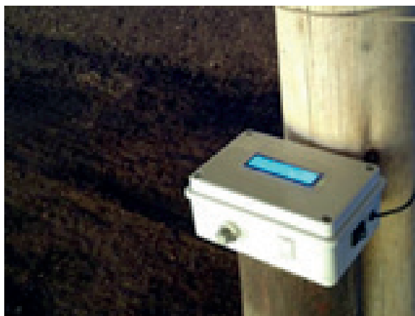
Figura 1. Datalogger desarrollado para el monitoreo de \text{NH}_3 , temperatura y humedad ambiente del galpón.
