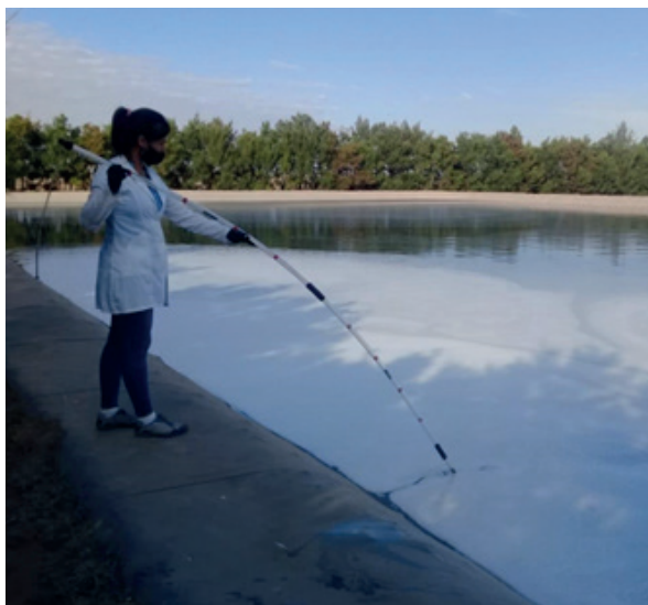
Figura 1. Muestreo de efluente porcino en laguna de estabilización con sonda Sludge Judge HACH.
