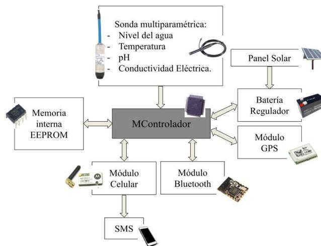
Figura 1. Esquema del prototipo de la estación de monitoreo hidrológico.
