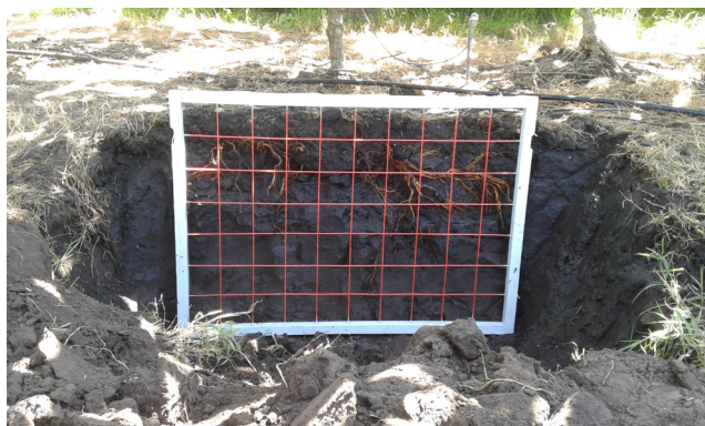
Figura 1. Marco de 1 x 0,70 m constituido por celdas de 0,10 x 0,10 m sobre la pared del perfil de una calicata en un lote de kiwi del sudeste bonaerense. 2016.
