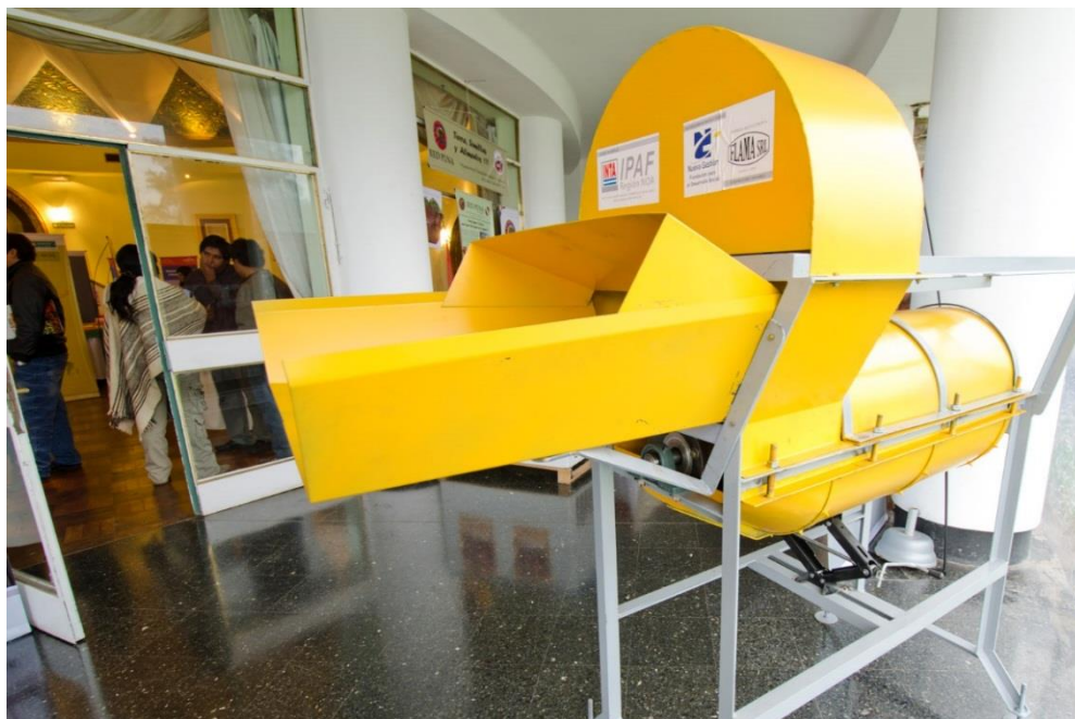
Foto N°8: 1° prototipo. Módulo de Trilla Axial (MTA-A)
