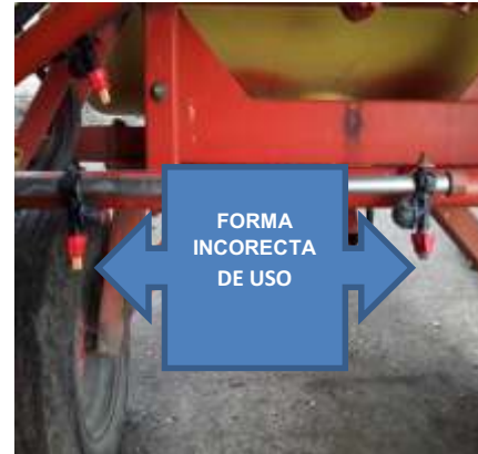
Figura 5. Picos defectuosos y desiguales
