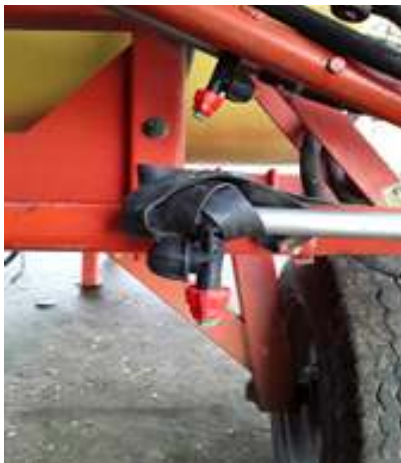
Figura 1. Cañería atada con goma
