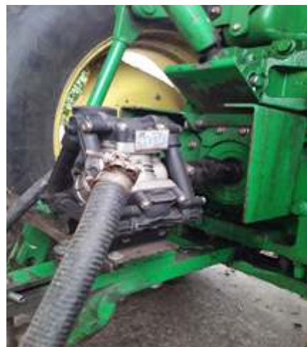
Figura 7. Bomba de la pulverizadora acoplada a la toma de fuerza.
