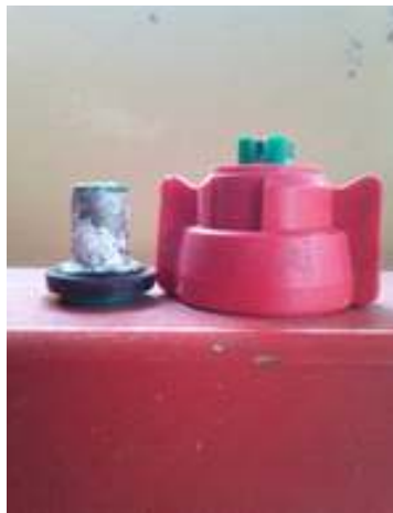
Figura 2. Filtro de pastilla obstruido
