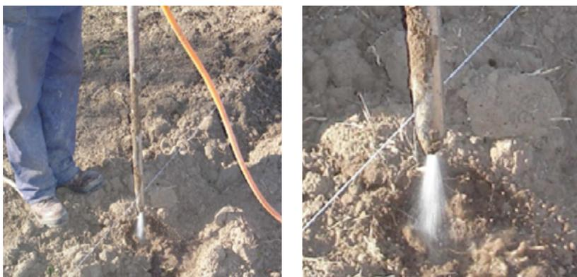
**Figura 19.** Detalle de la barreta hidráulica en funcionamiento (Fotos extraídas de Cancio y Thomas 2011).
