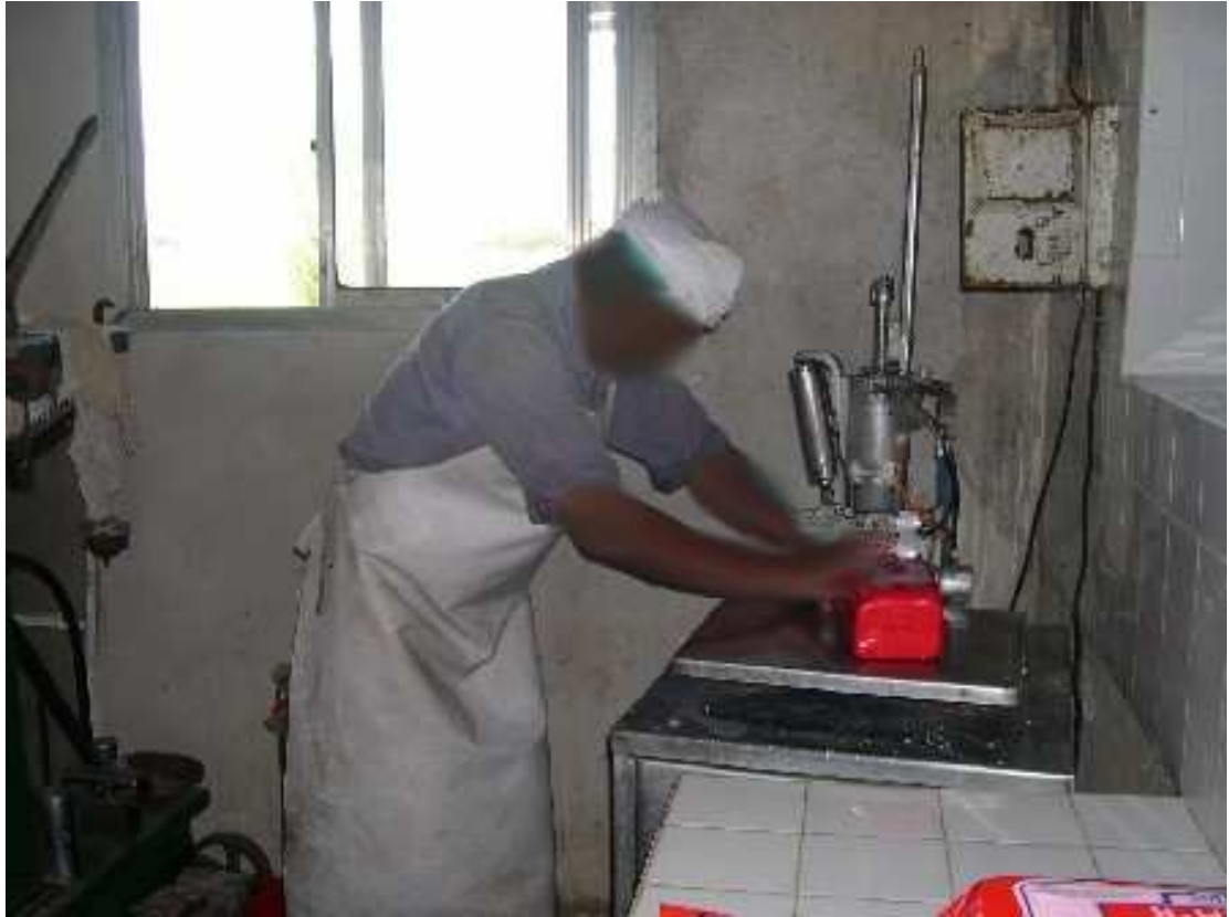
Figura N° 20: Vista de falta de protección de aberturas, en la zona de envasado.
