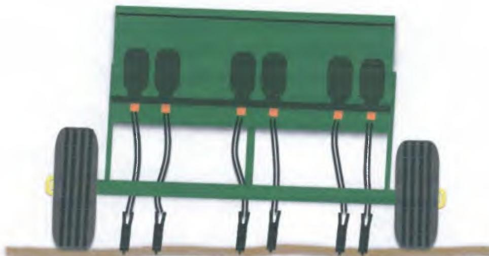
**Figura 20:** Desnivelado transversal a causa de usar rodado de diferente diámetro. Por este motivo y por la total ausencia de dibujo de las dos cubiertas, se procedió a cambiarlas por otras dos de rodado 600-16 de tipo agrícola, utilizadas comúnmente en las ruedas direccionales de los tractores de simple tracción.
