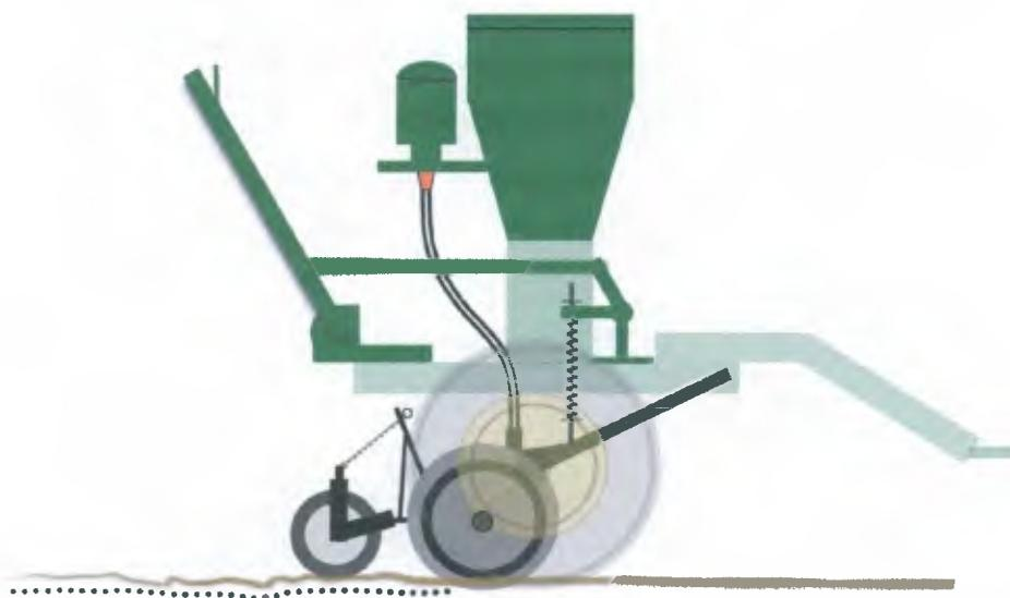
**Figura 19:** Detalle del mecanismo de levante.
