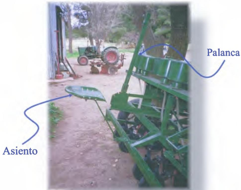
**Foto 18:** Detalle de la palanca y el asiento trasero.
