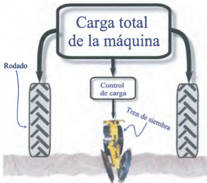
**Figura 15:** Esquema de cómo debe funcionar un mecanismo para el control de carga.
