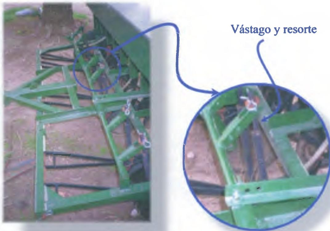
Foto13: Detalle del control de carga.
