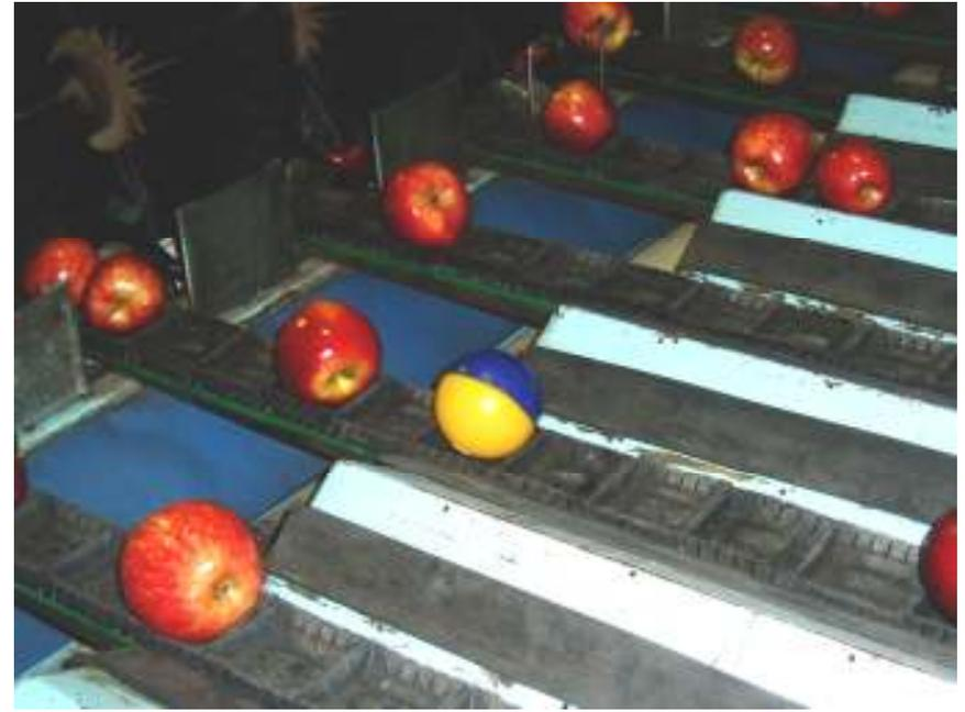
Medición de la intensidad y tiempo de duración de los impactos para la evaluación del potencial de daños en los procesos de línea de empaque.
