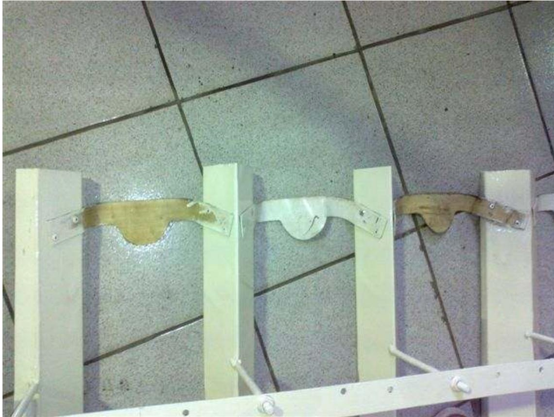
Construcción de las rampas con material de cinta, sobre las guías divisorias de la tamañadora.
