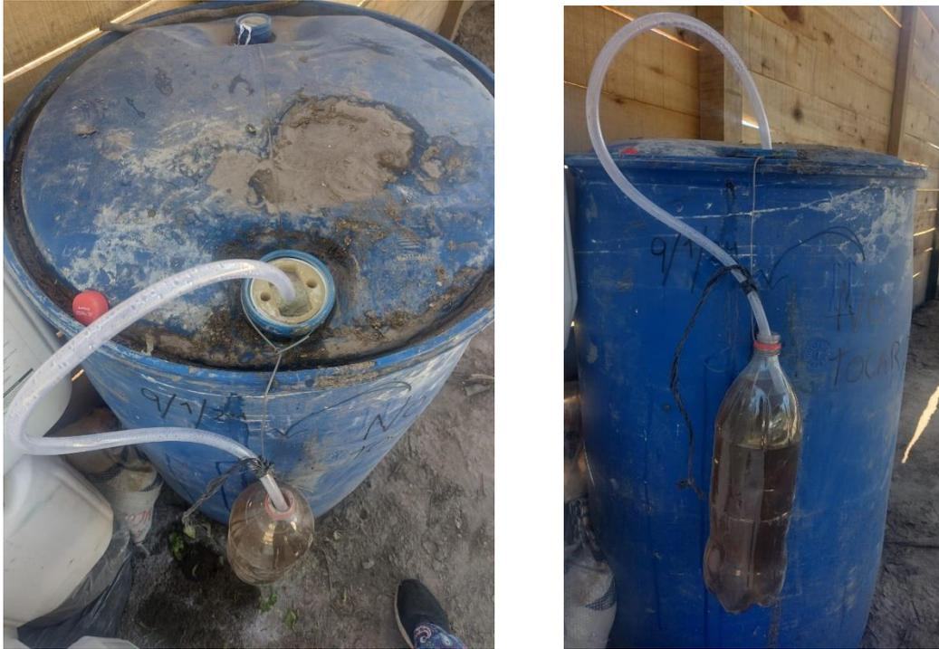
**Figura 6. A y B** Detalle de tanque con trampa de oxígeno colocada: manguera y botella con agua, experiencia con Cooperativa de Agricultores en Colonia Juliá y Echarren, foto tomada en febrero de 2024.
