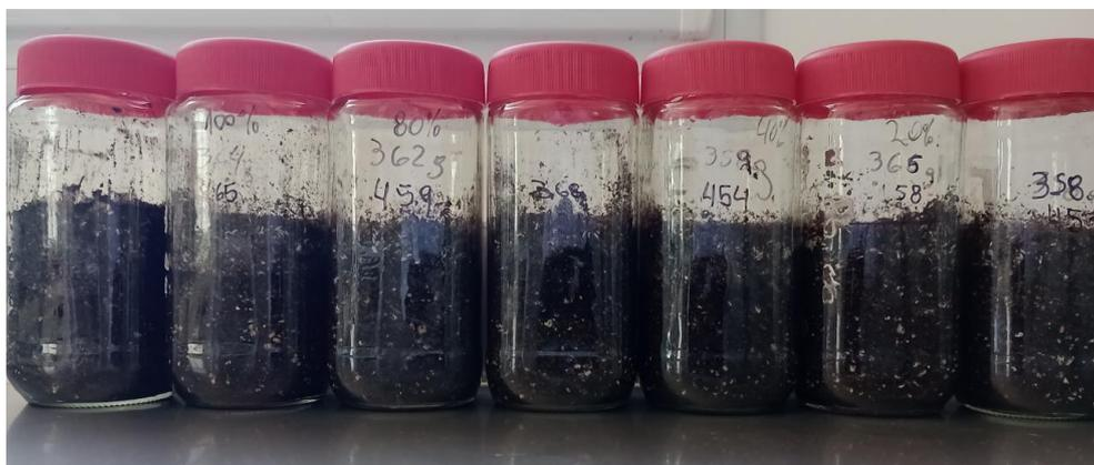
Figura 11. Test cerrados, bioensayo utilizando distintas concentraciones de digerido para regar y observar efecto en raíces.
